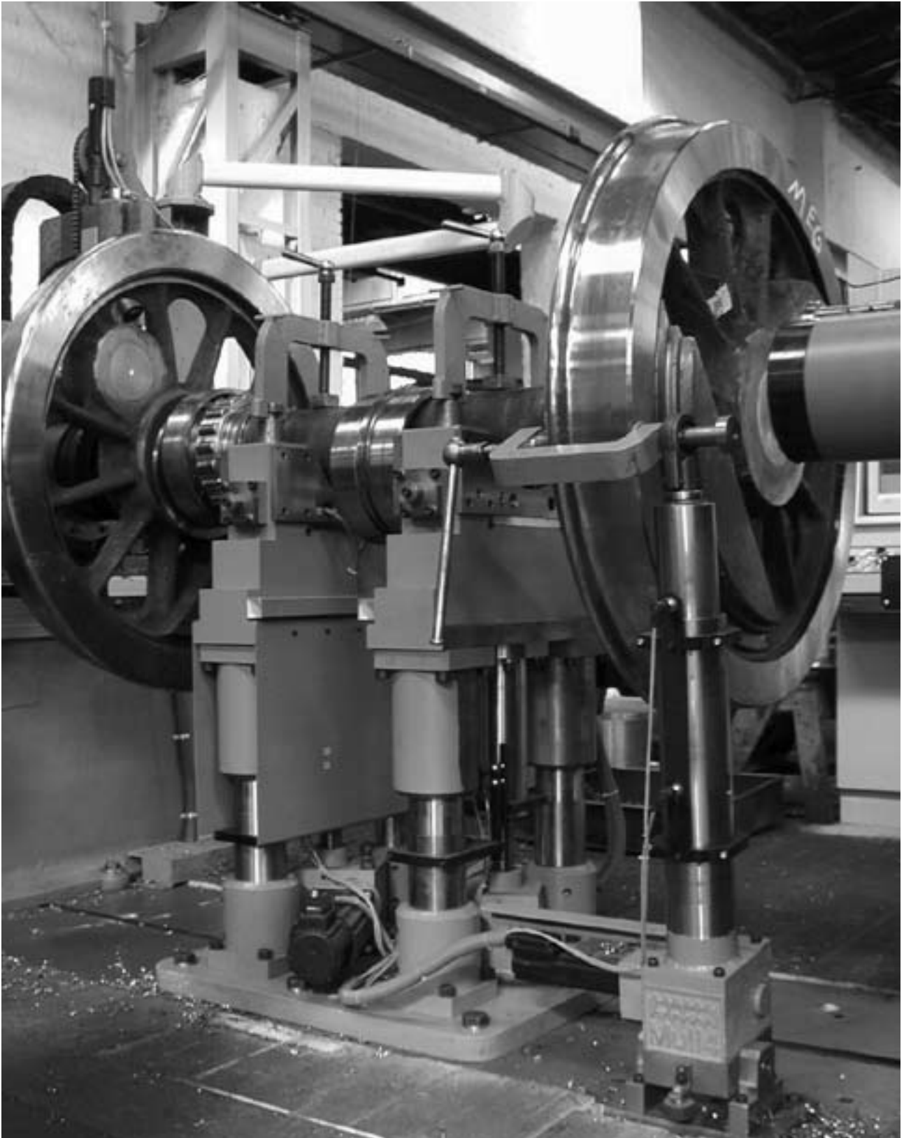
Vermessung von Radsätzen für Stangenlokomotiven, Fa. Hörmann Bahntechnik/ Surveying axles for rod locomotives, Hörmann Railway Technology, Germany
